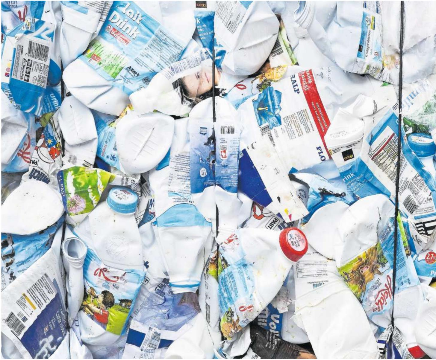
Milchflaschen aus Plastic: Rohmaterial für Isolationsrohre.
